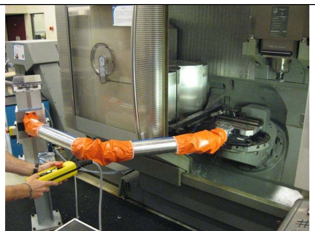
Bras manipulateur de palette : bras en position
