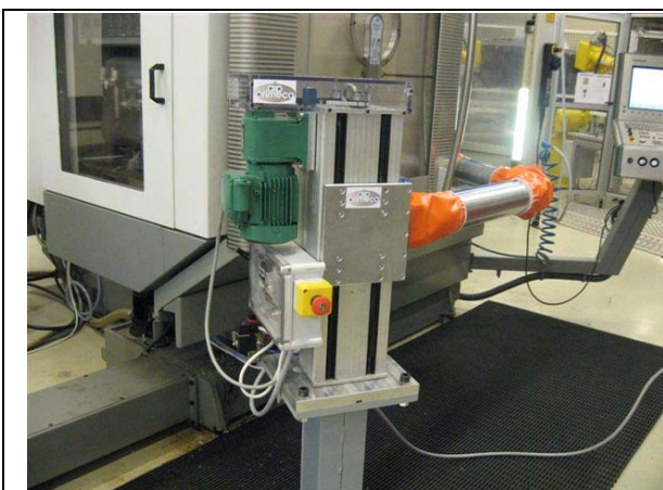
Bras manipulateur de palette : support motorisé
