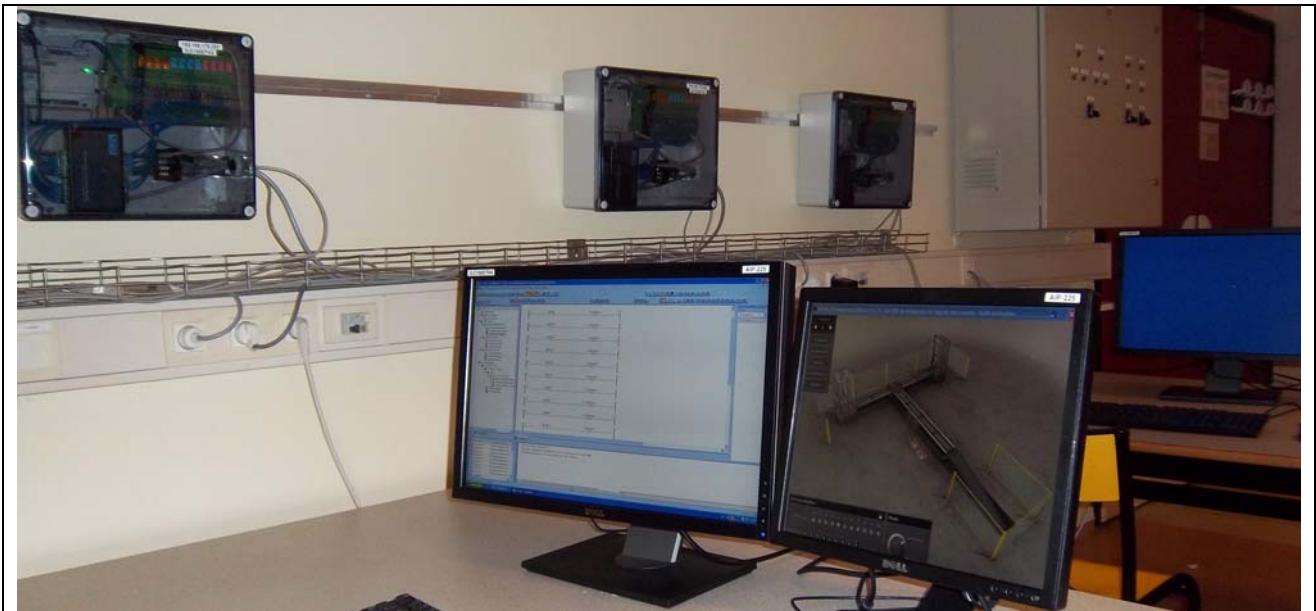
Maquette de simulation de P.O. : Coffret API, PC programmation et PC simulation
