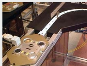
Lecture de l'étiquette à l'entrée du poste
